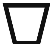
tipologia di crimpaggio per puntalini
