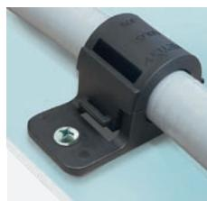
**HDLCC/HDLCC-M: Collarini per impieghi gravosi in plastica, disponibili anche con lingua di fissaggio in acciaio.** Antifiamma e molto robusti, sono dotati di chiusura a scatto per un rapido preassemblaggio coi cavi e un fissaggio a parete semplificato. Possono essere utilizzati anche sui tubi corrugati ed è possibile riaprirli e poi riutilizzarli.
