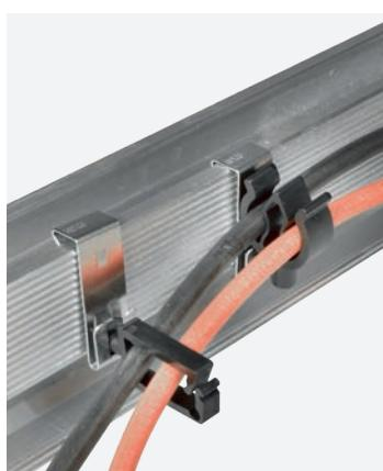
Ferma-cavi per clip modulari, disponibili in forma rettangolare (anche a 90°), in forma tonda con chiusura ad incastro e in forma ad albero (anche a 90°). Si agganciano alle clip modulari tipo CMF-CM e CPS-CM e consentono di fissare e organizzare cavi e fasci di cavi in varie dimensioni.
