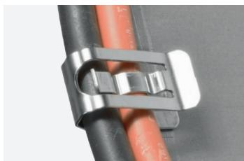
**CMF-IN: Clip per max 2 cavi, con cavi all'interno del telaio.** Clip orientate in modo che i cavi siano nascosti all'interno del telaio del modulo fotovoltaico. Adatte per cavi con diametro 5,1 - 8,4 mm ciascuno, per spessore telaio 1,4 - 3,2 mm.
