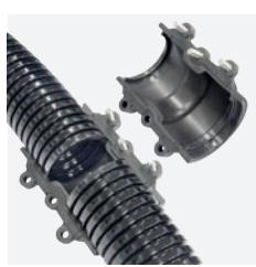
**Manicotti di riparazione IP 68/IP 69.** Realizzati in poliammide e TPE, antifiamma e autoestinguenti UL94-V0, questi manicotti vengono utilizzati per creare solide giunture a tenuta stagna tra spezzoni di tubo corrugato. Si montano/smontano molto facilmente, sono resistenti all'impatto, sono adatti per applicazioni statiche o dinamiche e sono resistenti ai raggi UV.
