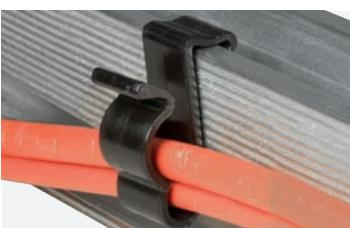
**CPS-2C-P: Clip in plastica per max 2 cavi.** Clip adatte per cavi per micro-inverter con diametro 7,6 - 12 mm ciascuno, per larghezza bordo del profilato 2 - 9,7 mm. Sono le uniche realizzate in poliammide 66 con ottima resistenza meccanica, resistenza ai raggi UV e protezione contro la corrosione.
