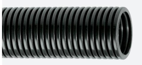
**PP: Tubo corrugato in polipropilene (UL94-HB).** Tubo con buona flessibilità e un'elevata resistenza all'acqua, alle soluzioni idrate, agli alcali e agli acidi, oltre a un'ottima resistenza ai solventi. Offre una buona protezione dai raggi UV e eccellenti proprietà di isolamento poiché le caratteristiche del materiale non sono influenzate dall'umidità. Disponibile con diametro interno 6,9 - 48 mm max.
