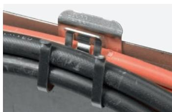
**CMF-2S: Clip per max 4 cavi (2+2 cavi sormontati).** Clip adatte per cavi con diametro 6,6 - 8,4 mm ciascuno, per spessore telaio 0,8 - 2 mm. Sono adatte per telai con bordi molto stretti.
