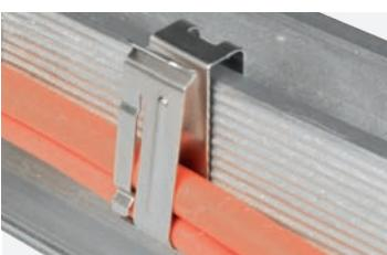
**CPS-CP: Clip per cavi ovali o più cavi tondi.** Clip adatte per cavi ovali per micro-inverter con dimensione 6,4x25,4 mm e anche per cavi tondi, per larghezza bordo del profilato 2 - 6,4 mm. Sono realizzate in acciaio inox 410 estremamente robusto e resistente alla corrosione.
