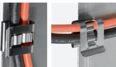
**CMF-BI: Clip bidirezionali per max 2 cavi.** Clip con doppio aggancio in modo da poter essere installate sia verticalmente che orizzontalmente. Adatte per cavi con diametro 5,1 - 8,4 mm ciascuno, per spessore telaio 1,1 - 2 mm.
