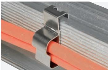
**CPS-2C: Clip per max 2 cavi.** Clip adatte per cavi per micro-inverter con diametro 7,6 - 12 mm ciascuno, per larghezza bordo del profilato 2 - 9,7 mm.
