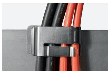
**CMF-90-4: Clip a 90° per max 4 cavi.** Clip progettate per fissare i cavi in posizione perpendicolare al telaio del modulo fotovoltaico. Adatte per cavi con diametro 5,1 - 7,6 mm ciascuno, per spessore telaio 1,4 - 3,2 mm.
