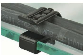
**CMF-PV: Clip per max 2 cavi, per pannelli in vetro.** Clip realizzate per essere installate direttamente sul pannello in vetro. Progettate per preservare l'integrità della superficie del vetro, sono rivestite in TPE per garantire un efficace isolamento elettrico. Adatte per cavi con diametro 5,1 - 8,4 mm ciascuno, per spessore telaio 3,2 - 6,4 mm.
