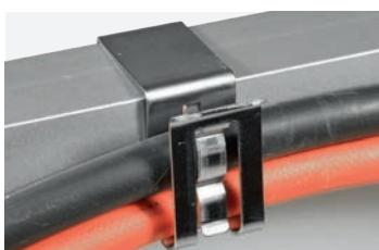
**CMF-SF: Clip per max 2 cavi, per moduli senza bordi.** Clip realizzate per i moduli fotovoltaici più recenti con telai privi del tipico bordo; vengono infatti installate direttamente sui telai. Adatte per cavi con diametro 5,1 - 8,4 mm ciascuno, per spessore telaio 13 - 18 mm.
