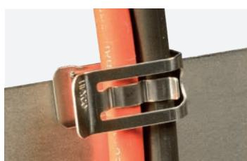
**CMF-90-2: Clip a 90° per max 2 cavi.** Clip progettate per fissare i cavi in posizione perpendicolare al telaio del modulo fotovoltaico. Adatte per cavi con diametro 5,1 - 8,4 mm ciascuno, per spessore telaio 0,8 - 3,2 mm. Disponibili anche per telai con bordi molto stretti.
