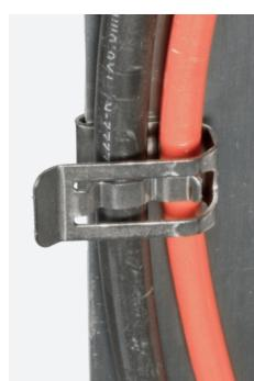
CMF-2C: **Clip per max 2 cavi.** Clip adatte per cavi con diametro 5,1 - 7,6 mm ciascuno, per spessore telaio 0,64 - 6,4 mm. Disponibili anche per telai con bordi molto stretti.
