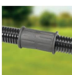
**Manicotti di accoppiamento e di derivazione.** Realizzati in morbido TPE resistente ai raggi UV, con forma dritta, a "Y" o a "T" questi manicotti vanno montati a pressione sulle estremità dei tubi e, grazie alla dentellatura interna, aderiscono perfettamente al profilo esterno dei tubi. Vengono utilizzati per creare una prolunga oppure una derivazione tra spezzoni di tubo, anche di dimensioni diverse.
